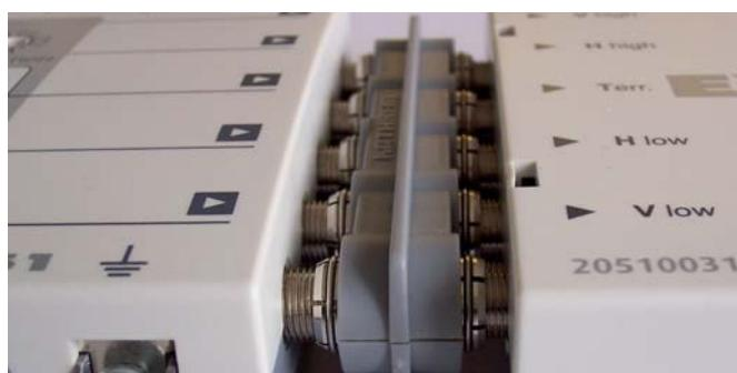
Si les appareils sont éloignés entre-eux, il est conseillé d'utiliser des câbles coaxiaux de qualité (à facteur de blindage très élevé), par ex. du LCD 111. Utilisez si-possible des connecteurs F de qualité (voir la figure de droite) à sertir ou à serrage (voir le catalogue Kathrein « Installations de réception satellite et terrestre »).
