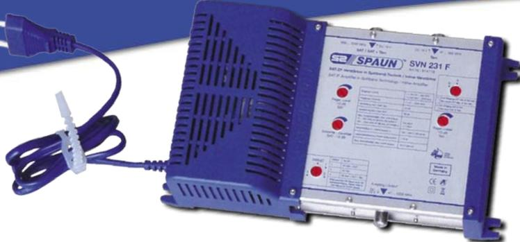
dass es keinen Unterschied in der Signalqualität vor und nach dem Verstärker gab. Die Differenz des MER Parameters war vom Eingang zum Ausgang vernachlässigbar gering, z.B. 13,2 dB zu 13,0 dB. In der Praxis bedeutet das, dass das Hintergrundrauschen des SVN 231 F so gering ist, dass er kein zusätzliches Rauschen zum C/N (Verhältnis Träger zu Hintergrundrauschen) hinzufügt.
