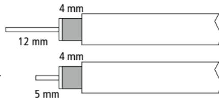
Nur SKB 395-xx: Entfernen Sie die äußere Aluminiumfolie der Schirmung. Stülpen Sie bei allen Kabeltypen das Geflecht nun nach hinten über den Außenmantel.
